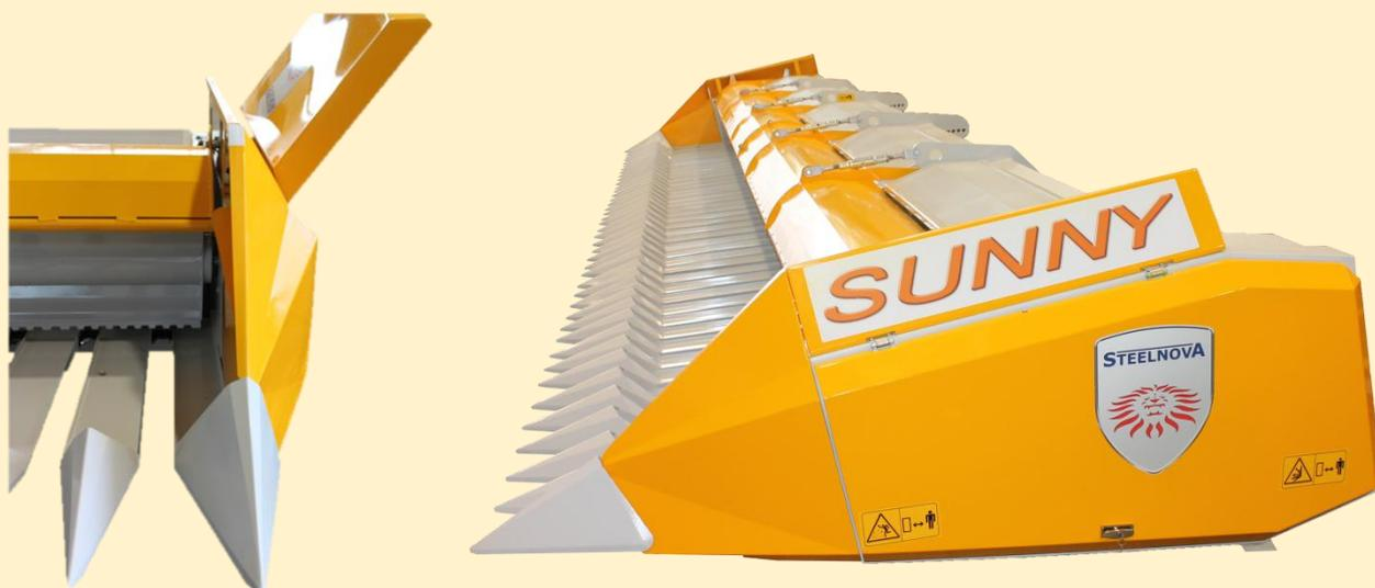
La nuova geometria delle fiancate permette di penetrare nel prodotto senza strappararlo e sommata al profilo ribassato per ottenere l'intera visibilità sull'area di taglio, rende il baricentro della testata più basso riducendo lo sforzo necessario alla mietitrebbia in fase di lavorazione.
