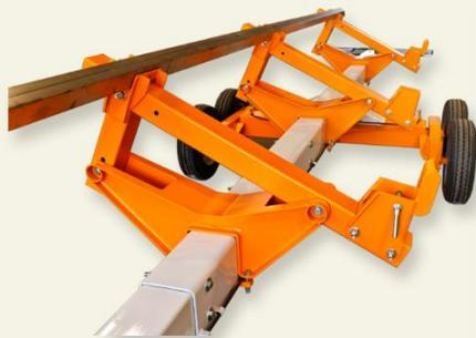
Supporti registrabili permettono di adattare il carrello per trasporto di qualsiasi testata anche quella completa di trinciastocchi.
